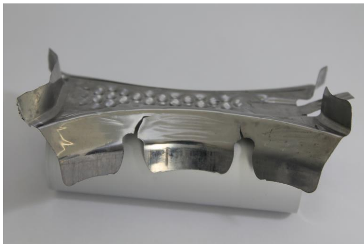
... die Analyse und Vorhersage von Materialfluss, Umformbarkeit, Falten und Oberflächendefekten.
