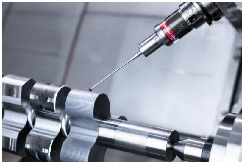
Der auf der M40 MILLTURN eingewechselte Messtaster TC63-DIGILOG auf der Oberfläche des gefrästen Rootsrotors. Der DIGILOG-Taster bewegt sich „scannend“ mit bis zu zwei Metern pro Minute und erzeugt so in kürzester Zeit tausende Messwerte. (Bilder: Blum-Novotest)
