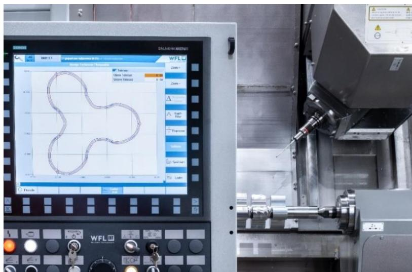
Darstellung der Kontur in der von WFL entwickelten Softwarelösung. Die schwarze Linie visualisiert das Soll-Maß, die blaue das gescannte Ist-Maß und die rote die vorgegebene Toleranz.
