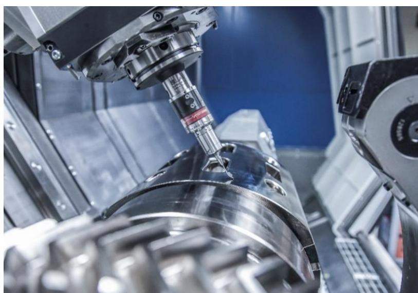
Die DIGILOG-Technologie von BLUM wurde bei WFL erstmals in Form des Rauheitsmessgerätes TC63-RG eingesetzt.
