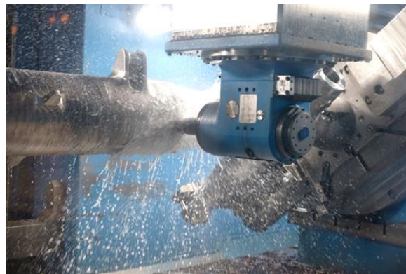
Die Hauptkomponente jedes Fahrwerksystems ist ein massives Schmiedestück, das bis zu acht Tonnen wiegen kann. Trotz Kühlmittel im Arbeitsraum liefert das Rauheitsmessgerät TC63-RG zuverlässige Ergebnisse.
