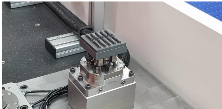
... auf dem Nullpunktspannplatz der Koordinatenmessmaschine (Zeiss Contura).
