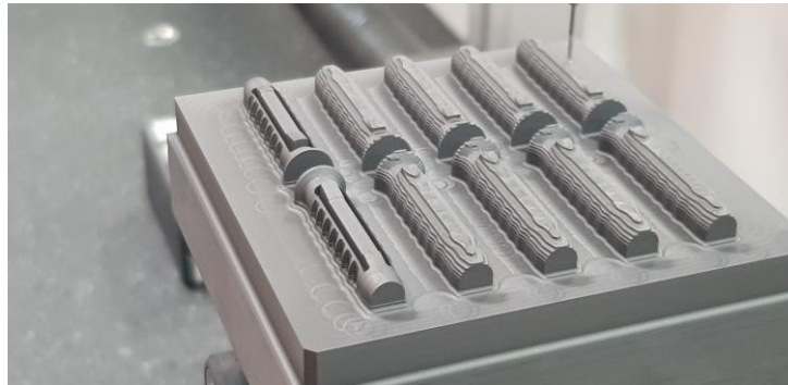
Vorschub verdreifacht: Die Beispielelektrode nach dem Schrappen und nach dem Schlichten ...
