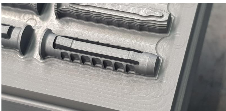
... der beiden linken 'Dübelhälften' auf Endmaß mit dem MOLDINO-Kugelfräser D-EPDB-2004-4.
