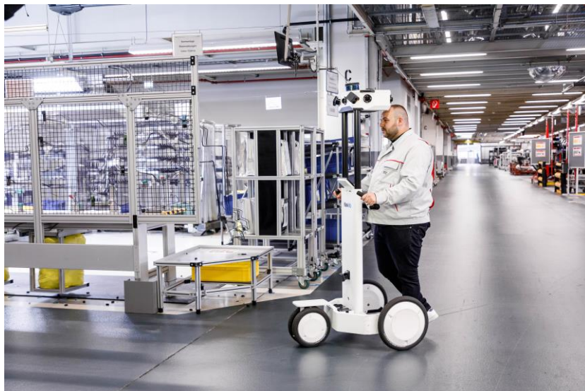
... schiebt man NavVis M6 durch die Fabrik. (Bild: Audi)
