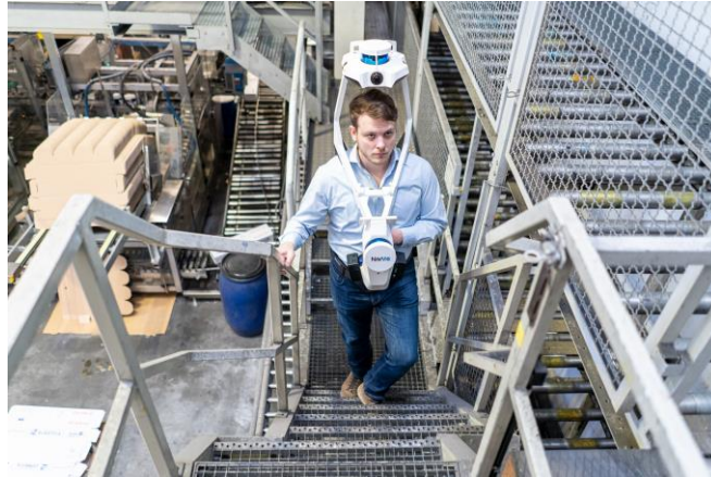
Während der Laser Scanner NavVis VLX getragen wird, ...
