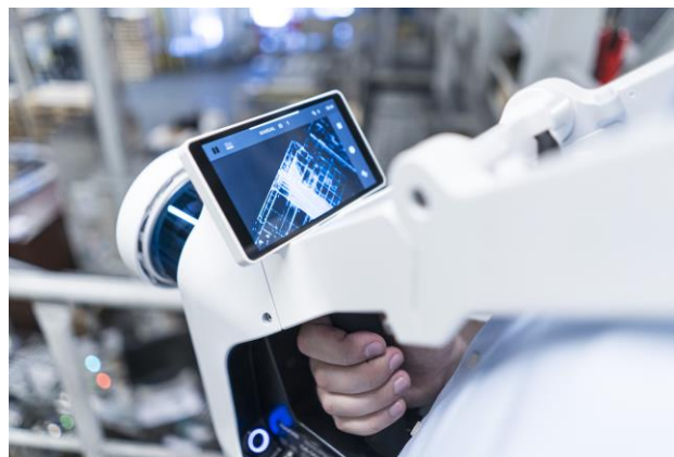
Die Datenerfassung kann auf einem Display verfolgt werden.
