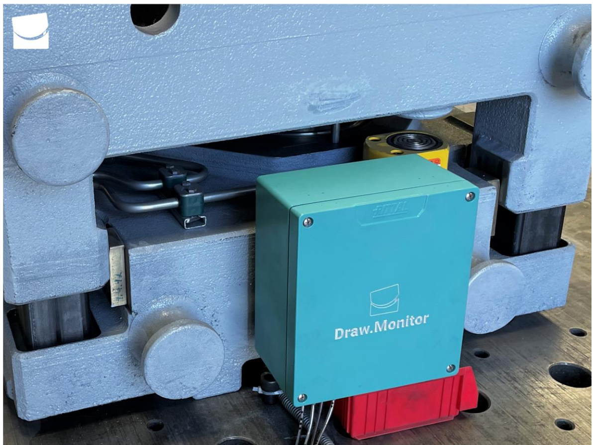
Messbox der Draw.Monitor an einem Prüfwerkzeug. (Bilder: iLARIZ GmbH)
