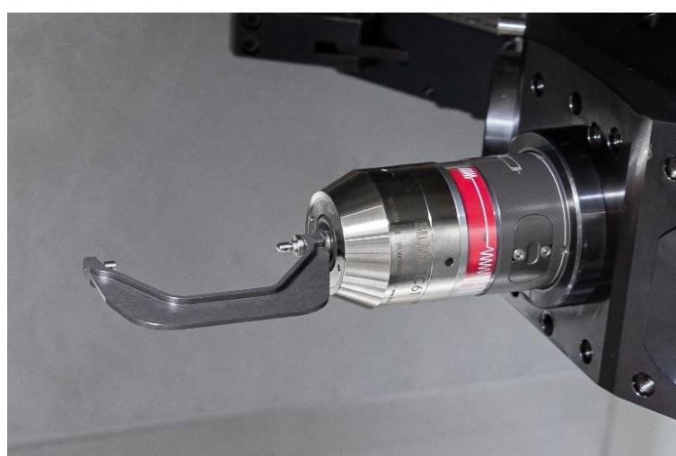
Das weltweit einzigartige bidirektionale Messwerk macht es möglich, den TC61 mit relativ schweren Tasteneinsätzen, in diesem Fall einem Messbügel, auszustatten. (Bilder: Blum-Novotest)
