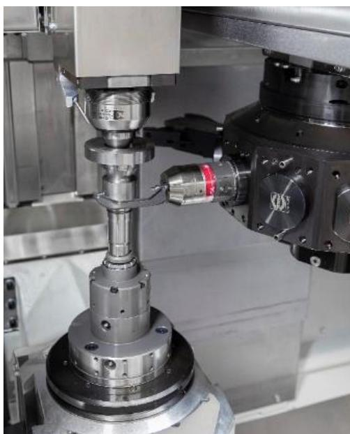
Zur Vermessung der Drehteile in der Maschine setzt Schuster den Messtaster TC61 von BLUM mit einem speziell entwickelten Tasteneinsatz ein.
