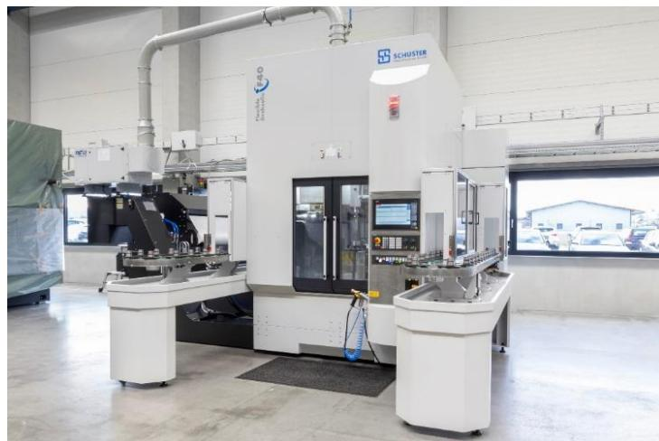
Schuster Maschinenbau setzt bereits seit vielen Jahren auf Fertigungsmesstechnik von BLUM. Auf der flexiblen Drehzelle F40 kommt beispielsweise der Messtaster TC61 zum Einsatz.
