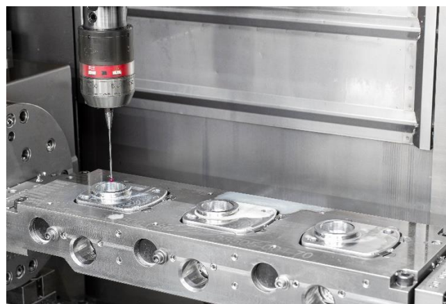
Messtaster von BLUM sind bei Scherzinger Pumpen teils seit Jahrzehnten im Zweischichtbetrieb im Einsatz.
