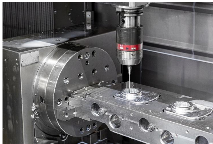
Mit den TC50-Tastern werden bei Scherzinger vor allem Bohrungen gemessen und Werkstückkanten angetastet.
