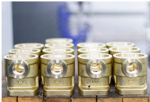
Teile aus Kupfer-Aluminiumlegierung (CUAL10Ni). Der Nickelanteil verleiht dem Material eine hohe Zähigkeit. Das führt dazu, dass Zerspanungswerkzeuge bei der Bearbeitung zum Klemmen neigen, weshalb eine Werkzeugüberwachung hier besonders wichtig ist. (Bilder: Blum-Novotest)
